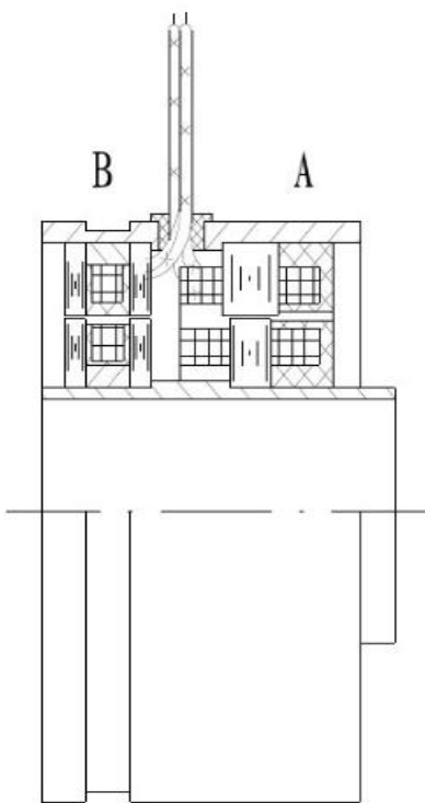
图 1、环形变压器式旋变结构示意图
